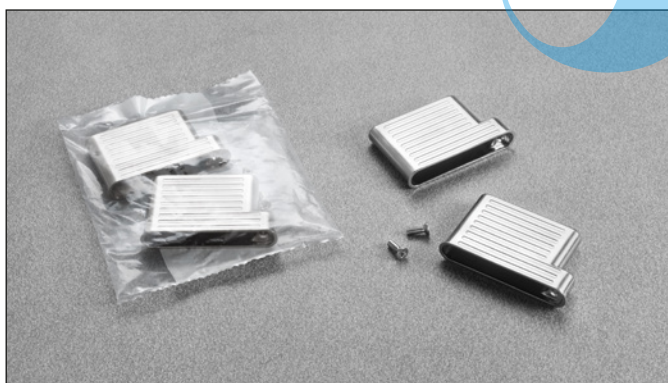
铰臂衬套，嵌入于柜体顶、底板 为 Air 提供额外的支撑强度，适用于更薄的材料；同时亦可掩盖板材铣型加工时的细微缺陷。
